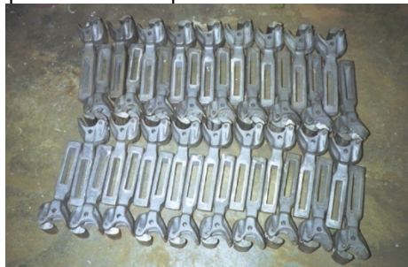
La primera partida d'enganxalls del tipus "alliance" preparats per muntar.
